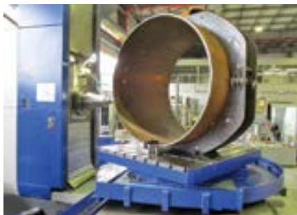
Рис. 1. Обработка корпуса расходомера на горизонтально-расточном станке с ЧПУ
