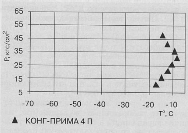
Рис. 4. Кривая конденсации углеводородов природного газа, построенная на основании измерений «КОНГ-ПРИМА 4П»
