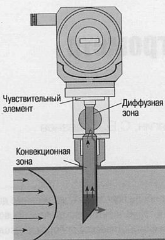
Схема работы преобразователя точки росы «КОНГ-Прима»
