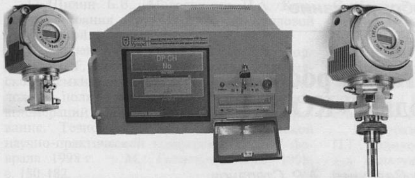
Рис. 1. Анализатор точки росы «КОНГ-Прима-4»: ЦУБ – в центре; ПТР в проточном исполнении – слева; ПТР в погружном исполнении – справа
